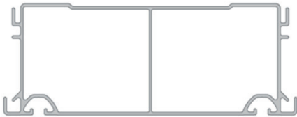
Doppelwandiger Systemaufbau: Schutz gegen Laserstrahlung bis 4 kW cw Nd-YAG Scheibenlaser
