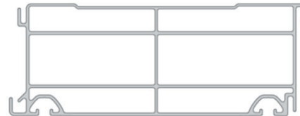
Vierwandiges System für Anwendungen im Fokusbereich: Schutz gegen Laserstrahlung bis 6 kW cw Nd-YAG Scheibenlaser
